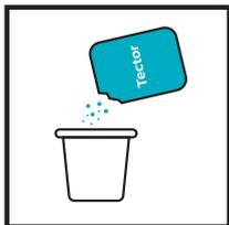
1. Vacíe en un recipiente de agua limpia. 6 litros para un saco de 20 Kg. 12 litros para un saco de 40 Kg.
